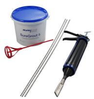
Instale dos (2) filas de dos (2) barras de amarre Stitch-Tie de PROSOCO de 6 mm y SureGrout S para crear una viga compuesta de mampostería que ayude a soportar la carga. Extienda las barras 20" más allá de la abertura en ambos lados. El espaciado vertical varía, comuníquese con un especialista técnico de anclaje de PROSOCO para obtener información más detallada.
